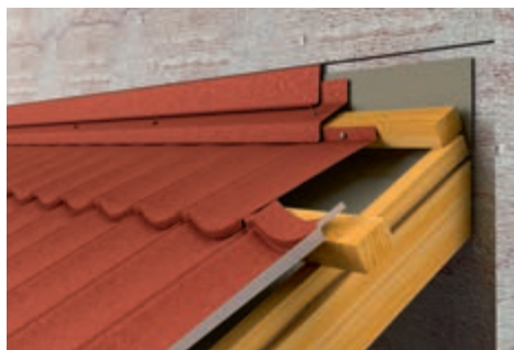
Рис. 31.1 Примыкание к стене
