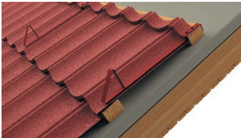
РИС. 36 Установка снегозадержателей
