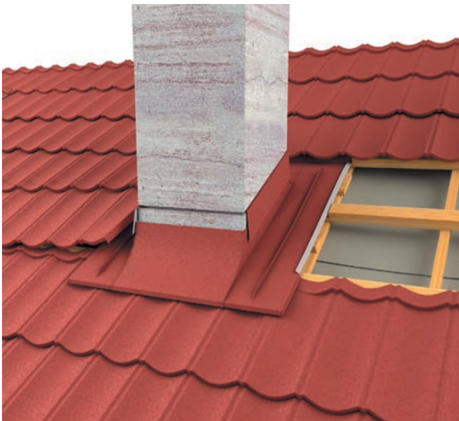
РИС. 32. 1 Примыкание к дымоходу с помощью оклада
