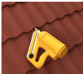
РИС.12.2 Крепление пневмопистолетом
